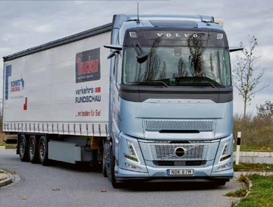
Zvenčí je aerodynamicky optimalizovaná předí jasně odlišitelná od standardního modelu.
